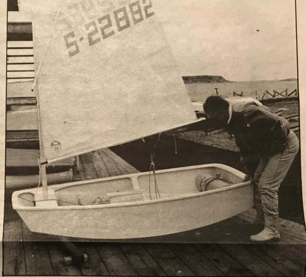
Optimist-jollen är en av de minsta (2,35 m) och populäraste jollarna. Båten riggas på land. Roder och centerbord monteras när båten kommer i vattnet. För att kompensera den korta masten, som gör båten lättare att transportera, används en extra mast, kallad sprimast.
